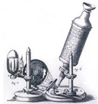
Figura. In questo microscopio, costruito da Robert Hooke nel Seicento, sono già presenti alcune parti dei microscopi moderni: il meccanismo di messa a fuoco, il piatto portaoggetti e il sistema di illuminazione del campione in osservazione.
