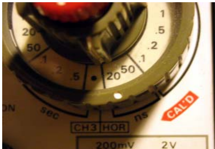
foto 1b - la regolazione della base-tempi.
