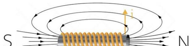
elettrotecnico costituito da un nucleo in materiale ferromagnetico (il chiodo) su cui è avvolto un solenoide, ovvero una bobina di molte spire di filo elettrico. Lo scopo dell'elettromagnete è di generare un campo magnetico da una corrente elettrica.
