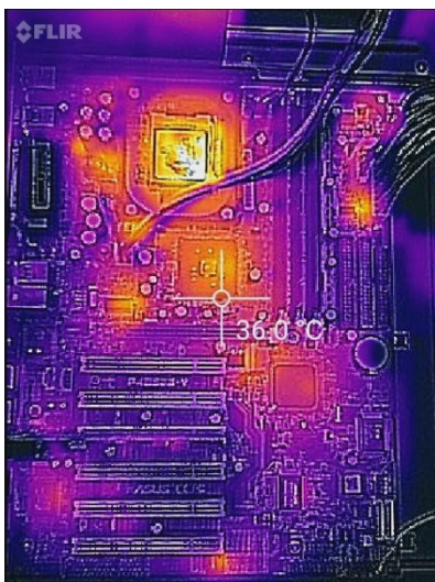
fase 3, si osserva la temperatura del processore dopo essere stato in funzione per 2 minuti con il raffreddamento di ventola e dissipatore
