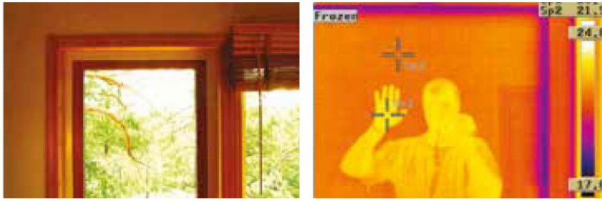
La finestra riflette la radiazione termica, quindi per una termocamera la finestra agisce come uno specchio.
